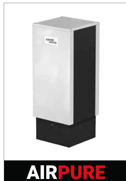
**AIRPURE** ist eine Lösung, die als Raumlufreiniger oder -absauger verwendet werden kann. Ausgestattet mit einem Gebläse mit variabler Geschwindigkeit, filtert es Luft von 200 bis 3000 m<sup>3</sup>/Stunde und führt potenziell kontaminierte Luft aus einem Raum zurück. Er ist völlig autonom, geräuschlos und leicht beweglich. In 5 Filterstufen saugt er die Luft von unten an und bläst sie von oben ab.
